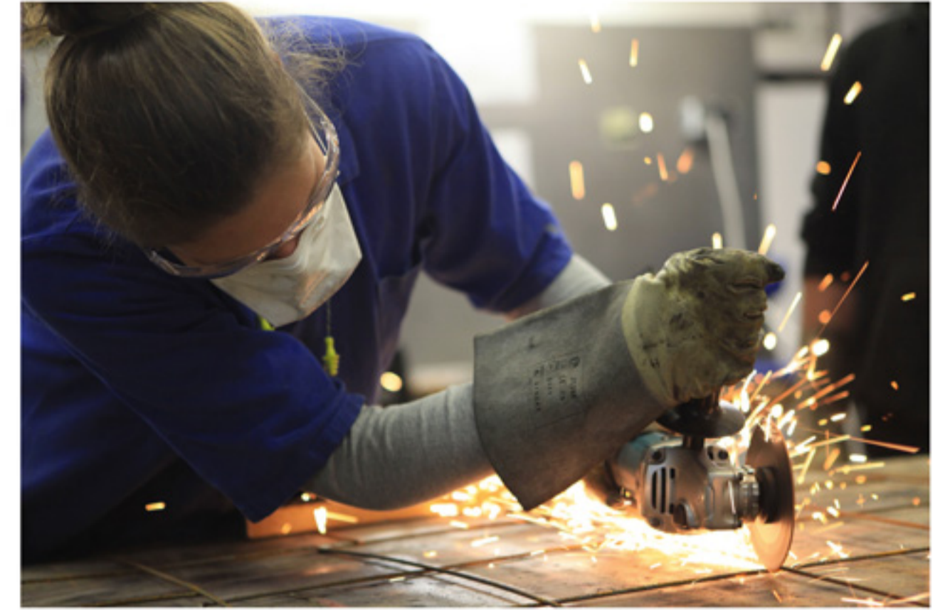
Découpe des treillis tresversaux
